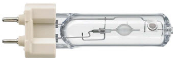
Figura 1: Lampada Mastercolour Evolution T 35 W. Il bruciatore è la componente sferica all'interno dell'involucro in quarzo della lampada.
